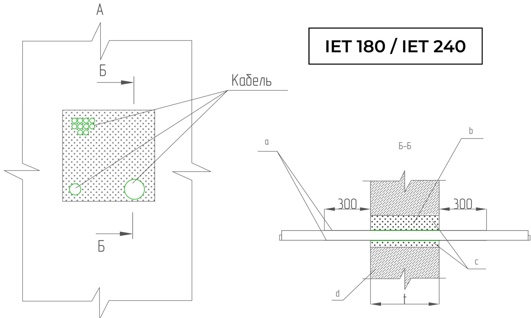
а - покрытие огнезащитное "НН FC-600", нанесенное на кабельные изделия, толщиной сухого слоя не менее 3,0 мм;
